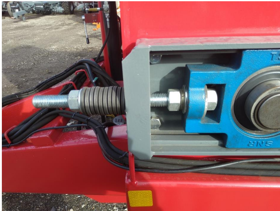
Fig. 6.2. Chain transporter tensioning bolt.
